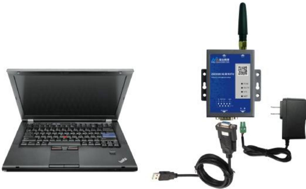
DTU 测试连接示意图
