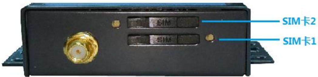
\*设备上电后，会先使用 SIM 卡 1，如果 SIM 卡 1 未插或登网失败，再自动切换到 SIM 卡 2
