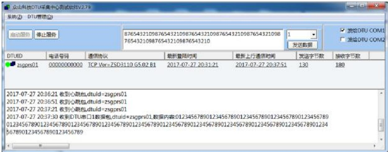
在数据采集中心和DTU设置程序中均提供了收发字节总数的统计显示，通过对比统计结果，可以知道数据采集中心和DTU之间的通信是否完全正确。
